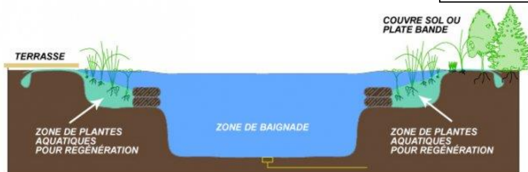
Figure 81 : Détail d'un fonctionnement de bassin.
