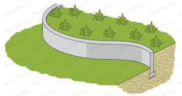
Figure 40 : Mur de soutènement d'un espace aménagé
