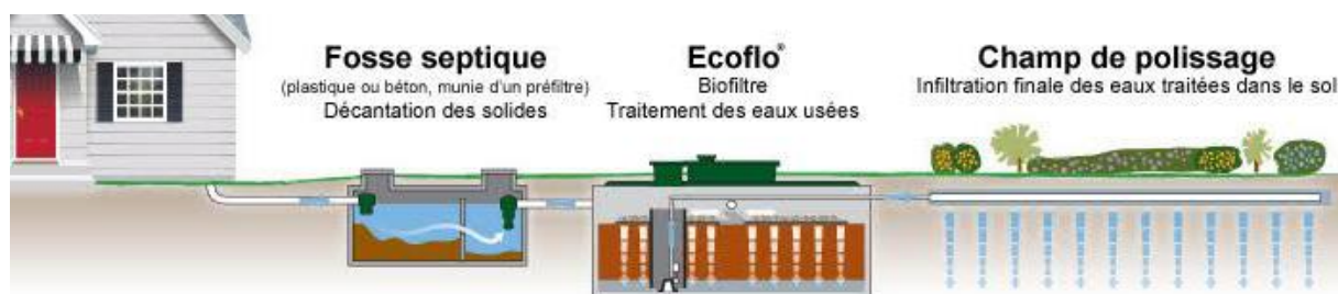
Figure 62 : Système Ecoflo Biofiltre 'traitement des eaux usées.
