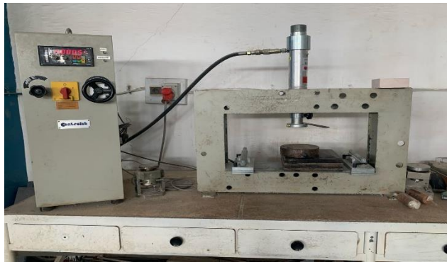
Figure 3.16 : Machine d'essai de compression
