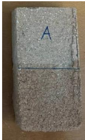
Figure 3.33: état de brique de group A après l'essai de tenue à l'eau par immersion.
