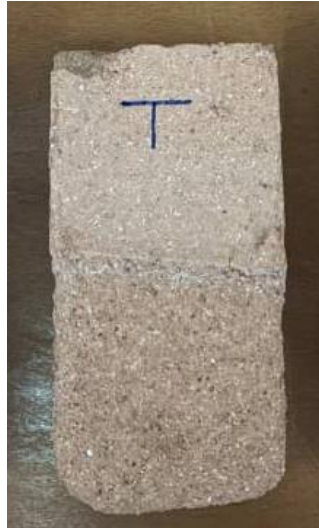
Figure 3.26 : état de brique du groupe T après l'essai de tenue à l'eau par immersion.
