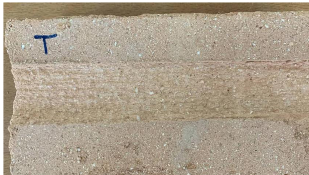
Figure 3.27 : état de brique du groupe T après l'essai d'abrasion
