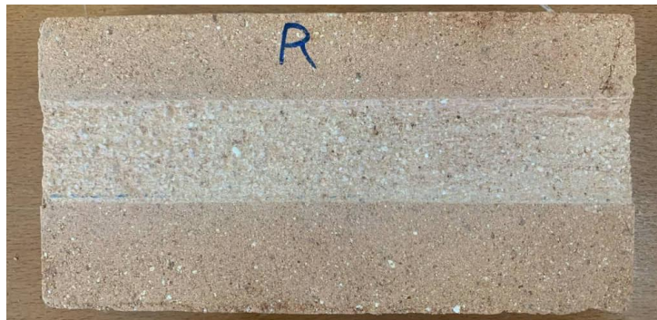
Figure 3.54 : état de brique du groupe R après l'essai d'abrasion
