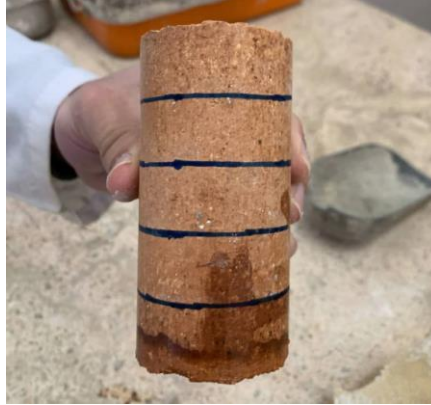
Figure 3.17 : Détermination du front de remonté capillaire
