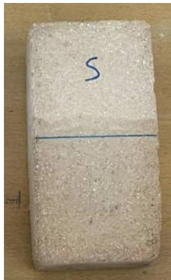
Figure 3.68 : état de brique du groupe S après l'essai de tenue à l'eau par immersion.
