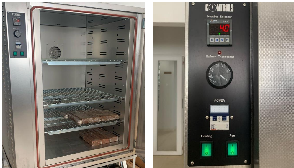
Figure 3.15 : Séchage des éprouvettes dans une étuve à 40 °C
