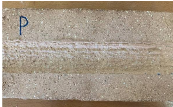
Figure 3.62 : état de brique du groupe P après l'essai d'abrasion
