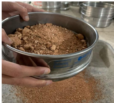
Figure 3.9 : tamisage de tuf avec un tamis de 2mm
