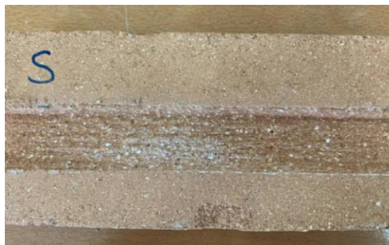
Figure 3.70 : état de brique du groupe S après l'essai d'abrasion
