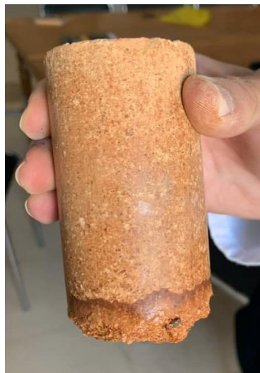
Figure 3.59 : État de l'échantillon du groupe P après 2h
