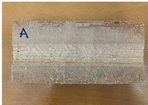
Figure 3.35 : état de brique de groupe A après l'essai d'abrasion
