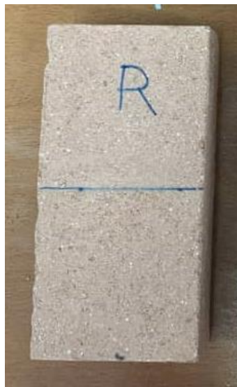
Figure 3.52 : état de brique du groupe R après l'essai de tenue à l'eau par immersion.
