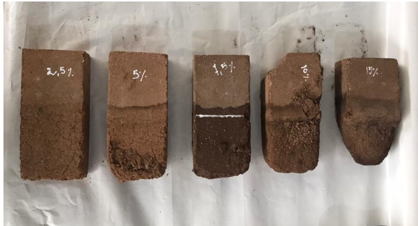
Figure 2.16: état des briques après l'essai de tenue à l'eau par immersion [38]
