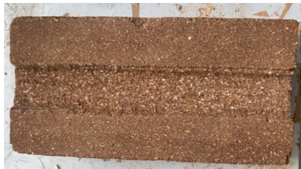
Figure 3.41 : état de brique du groupe B après l'essai d'abrasion
