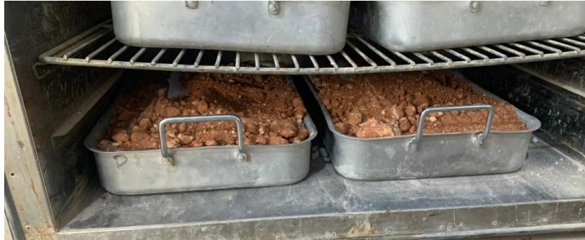
Figure 3.8 : mettre du Tuf dans l'étuve à 105°C
