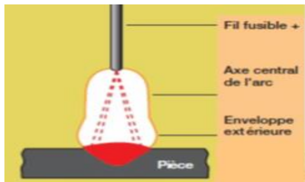
Figure 26.b : arc dans une atmosphère d'hélium ou d'oxyde de carbone [14]
