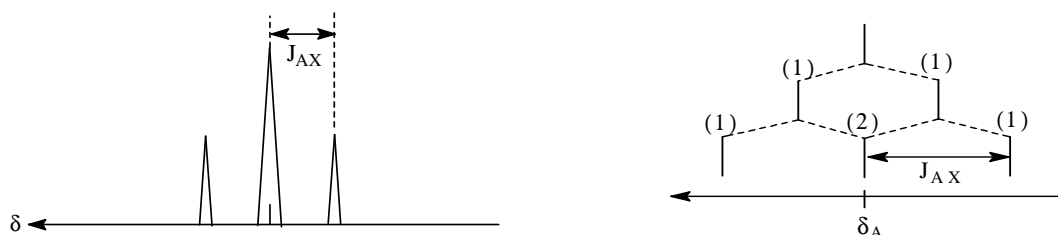
Figure 21: La représentation du spectre du proton A soumis simultanément au couplage des deux protons X.
