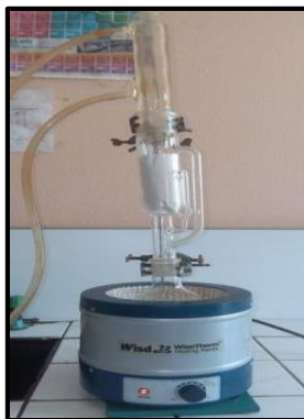
Figure 5 : Montage d'extraction du \beta -carotène.
