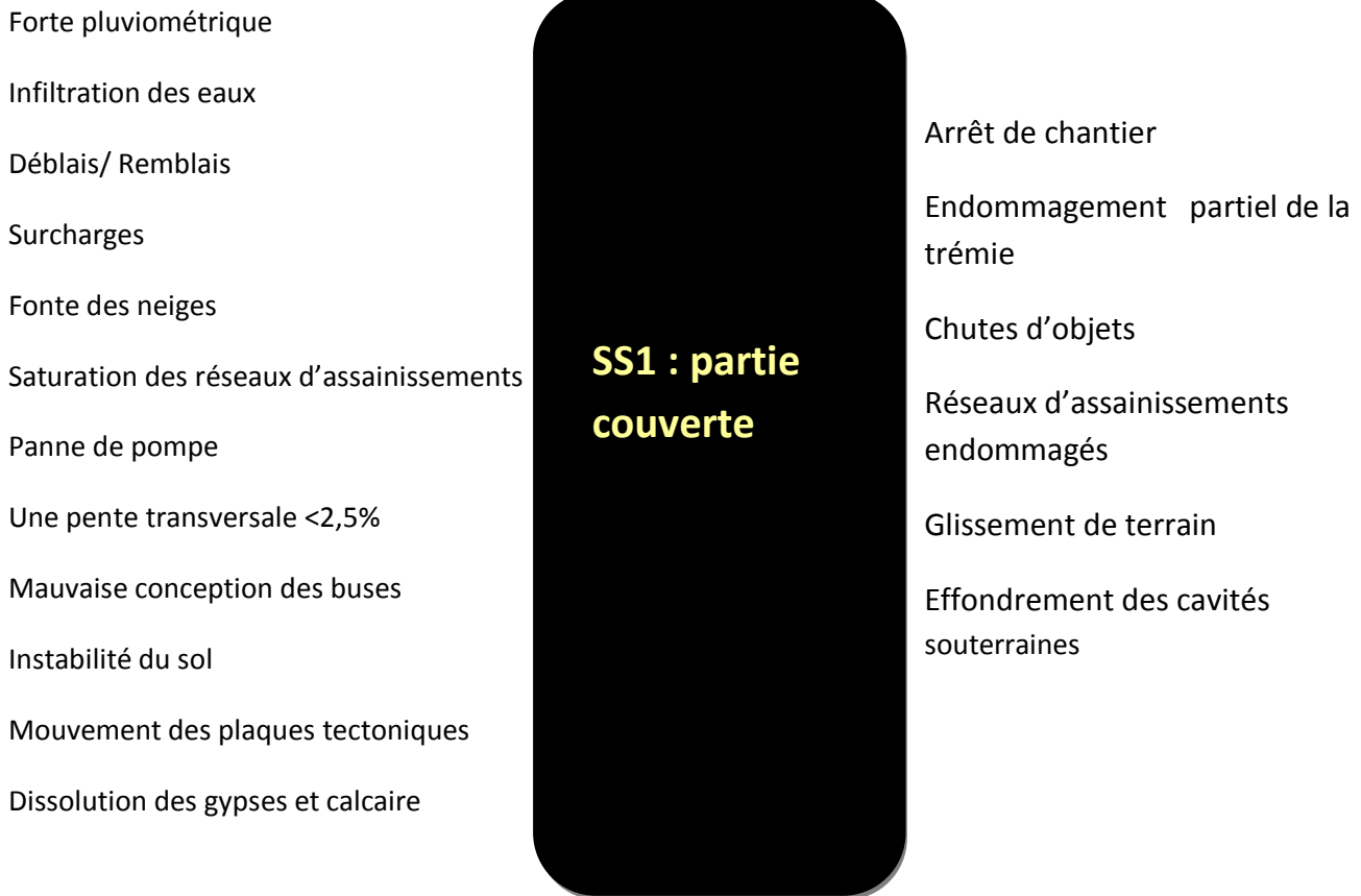
Figure 4.2 Construction des processus pour le SS1 (boîte noire partie couverte)
