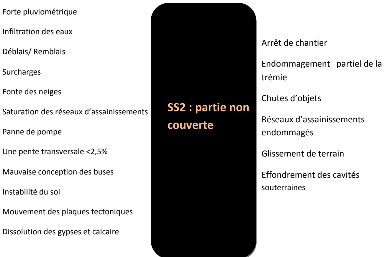
Figure 4.3 Construction des processus pour le SS2 (boîte noire partie non couverte)
