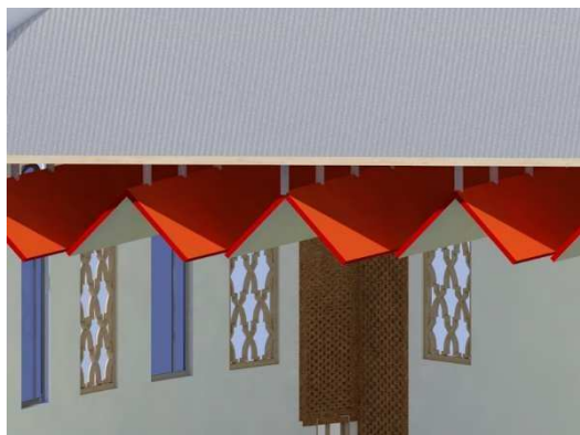
Figure 129: Les pannaux acoustique dans la salle de spectacle
