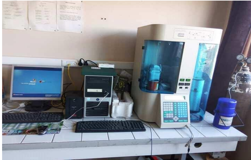
Figure II.2 : Appareil NOVA 1000e utilisé pour les mesures BET.
