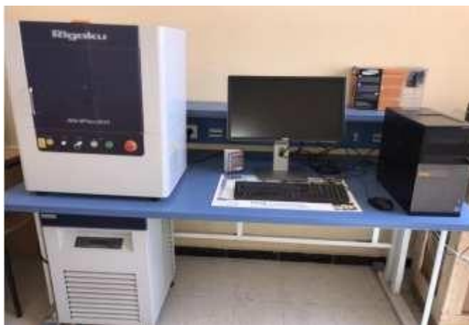
Figure II.3. Appareil DRX « Rigaku MiniFlex 600 »
