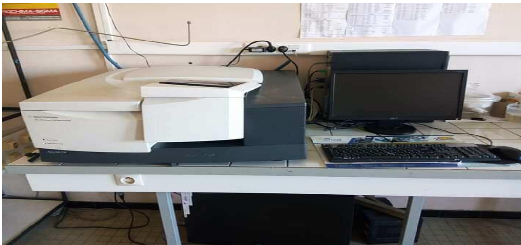
Figure II.4 : Appareil du spectromètre Infrarouge à Transformée de Fourier (IRT)
