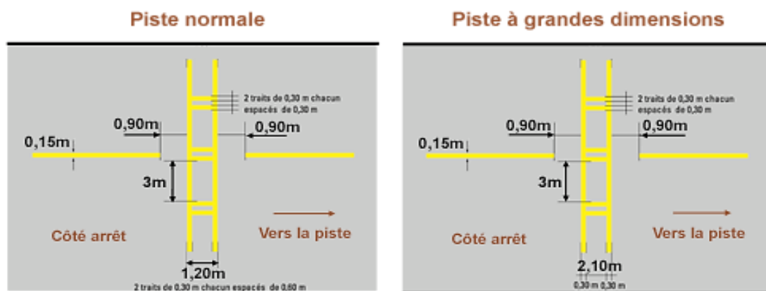
Figure 68- Point d'arrêt spécifique pour les pistes Cat.II et Cat.III [Avionnaire]
