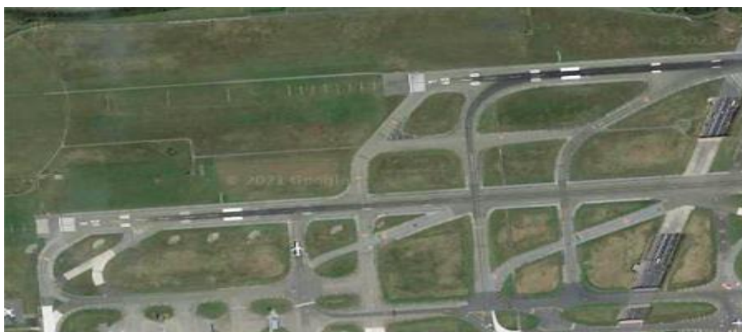
Figure 71- Point d'arrêt entre deux voies de circulation [Avionnaire]
