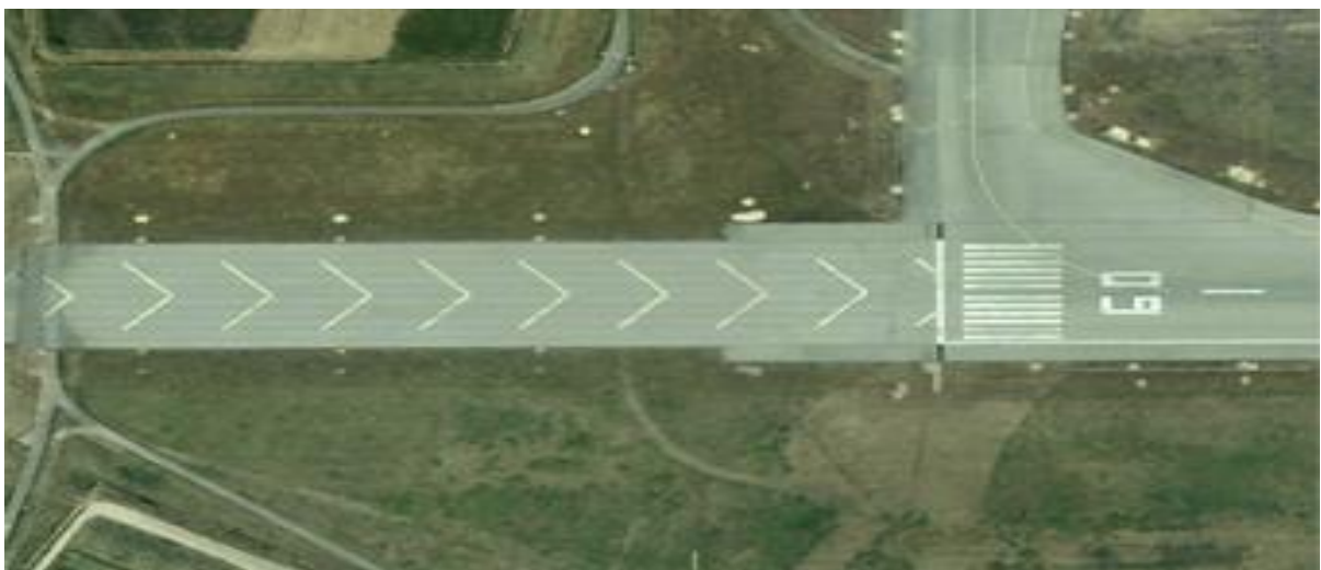
Figure 57- Zone anti-souffle et Prolongement d'arrêt [Avionnaire]
