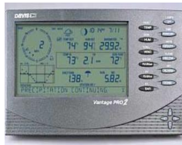
Fig.2.11 : Ecran d'affichage de la Station météo de type Davis Vantage Pro2
