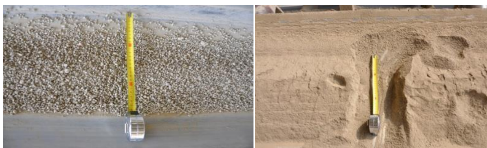
Figure II.4: illustration d'argile éliminée et l'argile obtenue après le tamisage.
