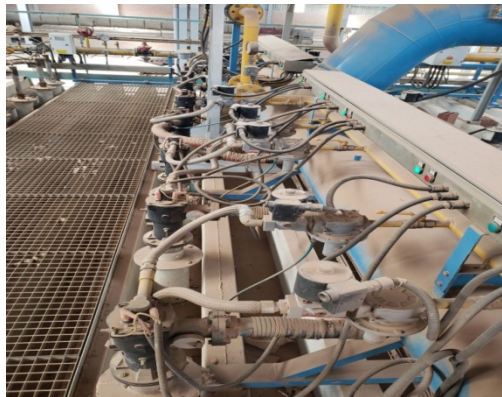
Figure II.9: les bruleurs hautes vitesses
