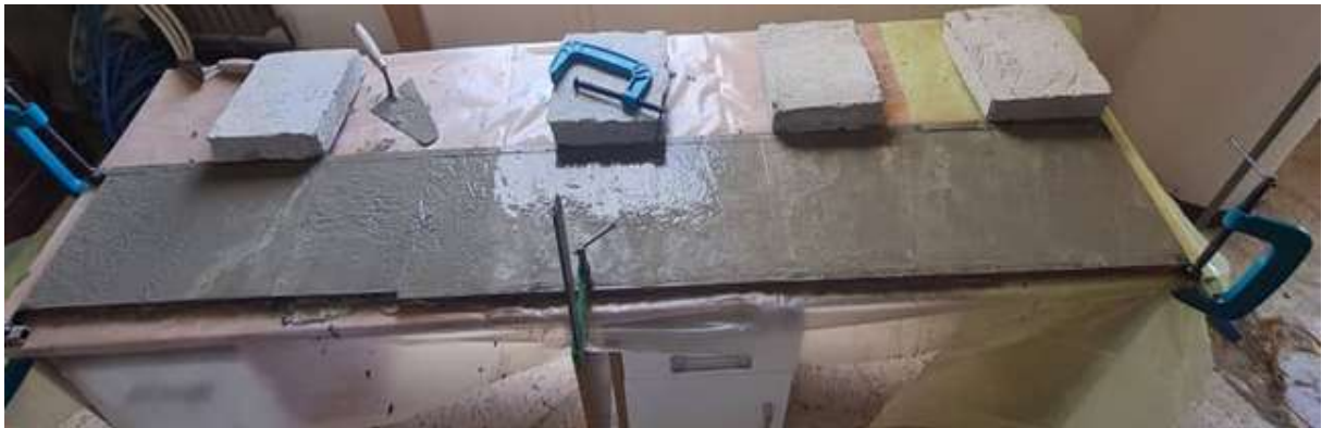
Fig. III.11. Etalage du mortier dans les moules.
