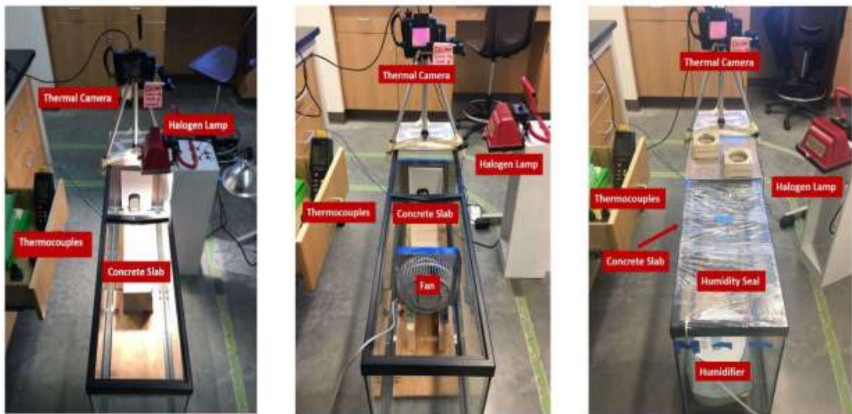
Fig I.4 Dispositifs expérimentaux de chauffage contrôlé (à gauche), de chauffage par circulation d'air (au centre) et de chauffage humide (à droite) pour l'échantillon de béton [3].
