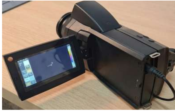
Fig. III.27. Caméra thermique infrarouge Testo 890.
