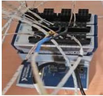
Fig III.23 Chaîne d'acquisition National Instruments (châssis NI cDAQ-9174 avec modules NI 9211)
