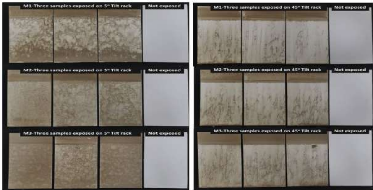
Fig I.14. Échantillons en triple exemplaire provenant de différents fabricants après 3 ans de vieillissement naturel à Ras al-Khaimah : (a) inclinaison de 5° et (b) inclinaison de 45° [11].
