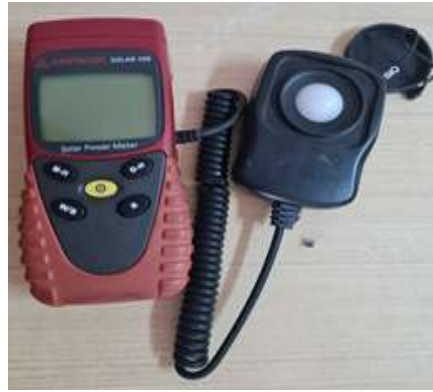
Fig. III.25. Solarimètre Amprobe SOLAR-100
