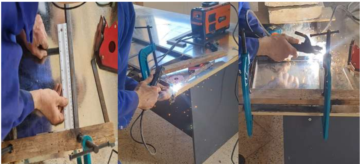
Fig III.5. Assemblage et soudage de moule
