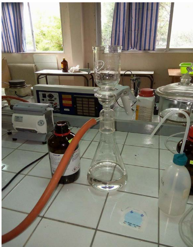
Figure II. 4 : Unité de micro-filtration par membrane à 0.45 \mu\text{m}
