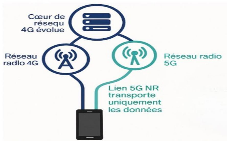
Figure II.6 : L'architecture du mode NSA
