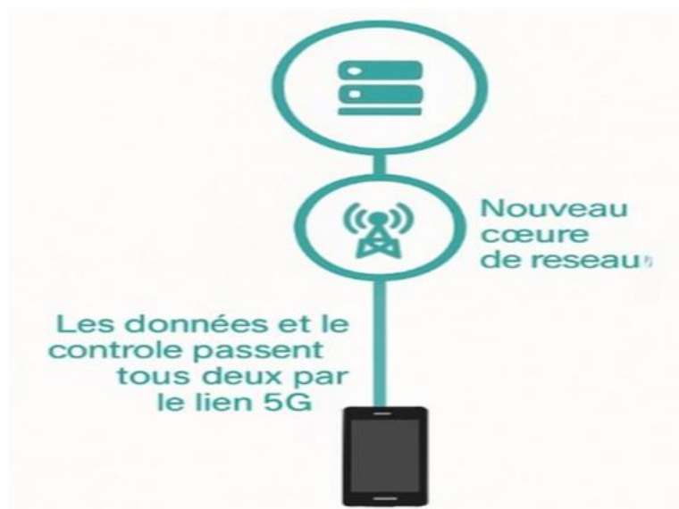
Figure II.7 : L'architecture du mode SA
