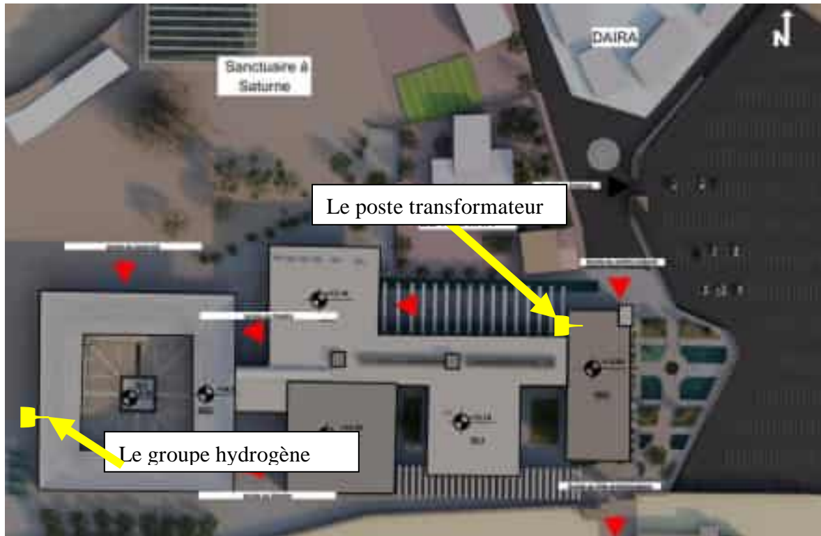
Figure 124: le déplacement de poste transformateur et du groupe hydrogène
