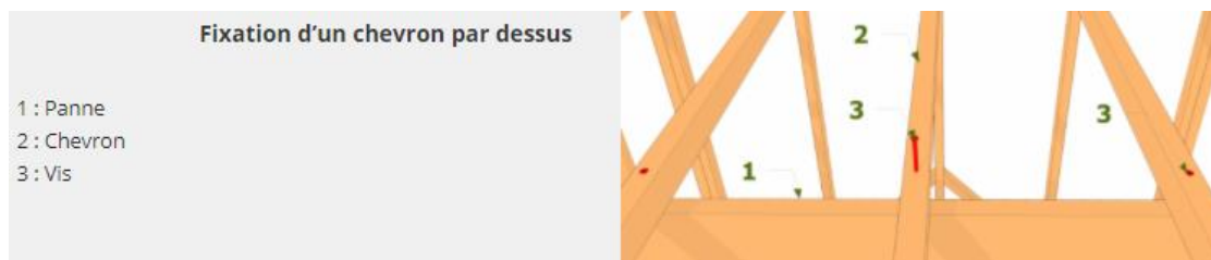
Figure207 : fixation d'un chevron par-dessus source : https://constructionbois.bilp.fr/guide-charpente/types/toiture-monopente/montage-charpente
