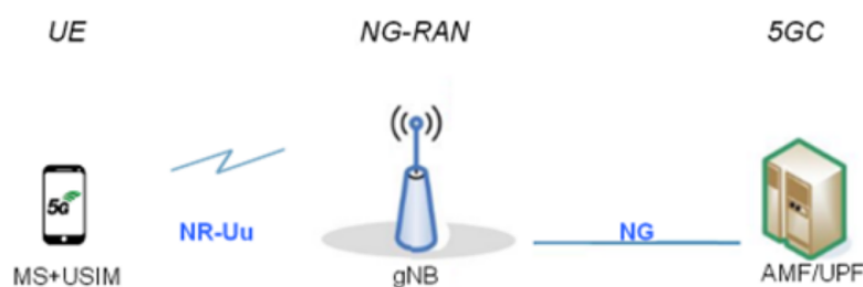
FIG. 3.4 : Architecture du réseau 5G.
