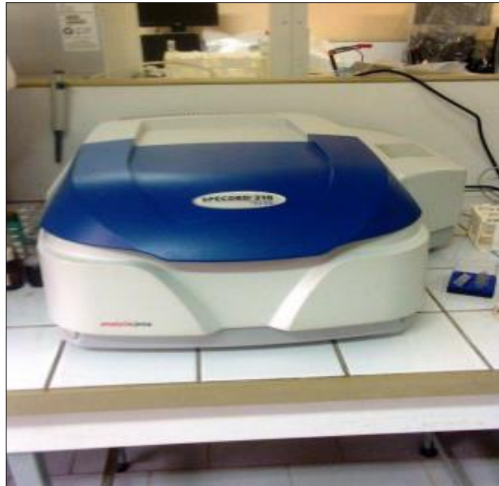
Figure 5 : Spectrophotomètre d'absorption UV-Visible «SPECORD 210 plus».
