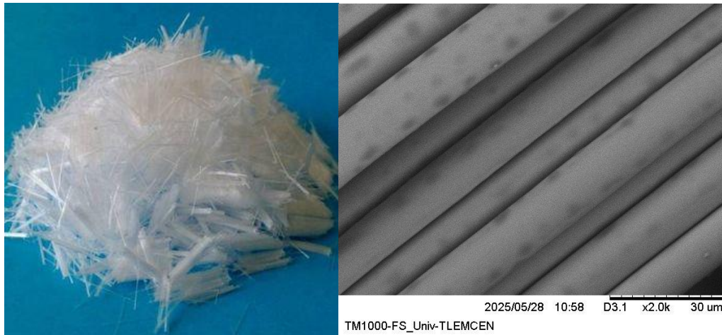
Figure 3.8 Fibres OCR à l'œil nu et au microscope électronique
