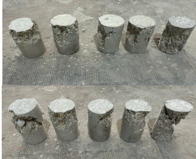
Figure 4.15 Aspect des éprouvettes suite à l'essai de compression
