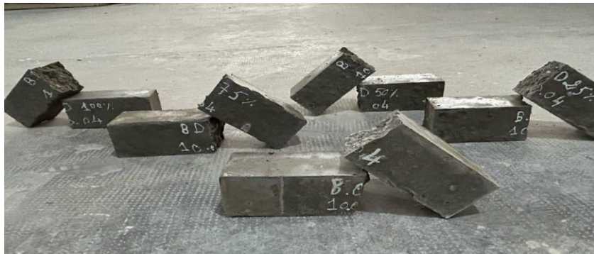
Figure 4.18 Aspect des éprouvettes suite à l'essai de flexion
