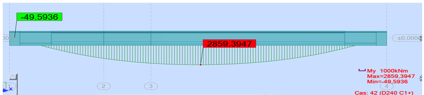
Figure VII.1 Diagramme de moment fléchissant dus a surcharge D240 de la poutre 3
