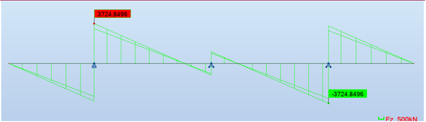
Figure X.10 diagramme d'effort tranchant (KN) à l'ELU
