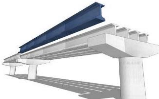
Figure III.1 Morphologie générale d'un pont à poutre
