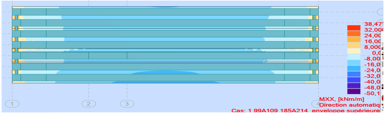
Figure VIII.3 Cartographie de la flexion longitudinale a ELS
