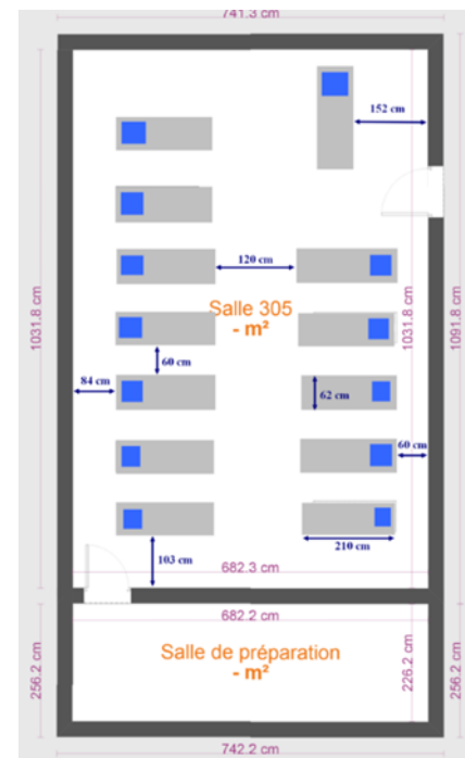
Figure 107 : Aménagement d'une salle de TP ,Laboratoire (ITRF Laboratoire, 2022)
