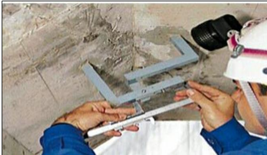
Photo 1 : Procédé de mesure des déplacements relatifs par vinchon(R.Nadia,2014)
