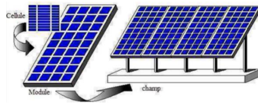
Figure 166. Composantes d'un champ de modules photovoltaïques.
