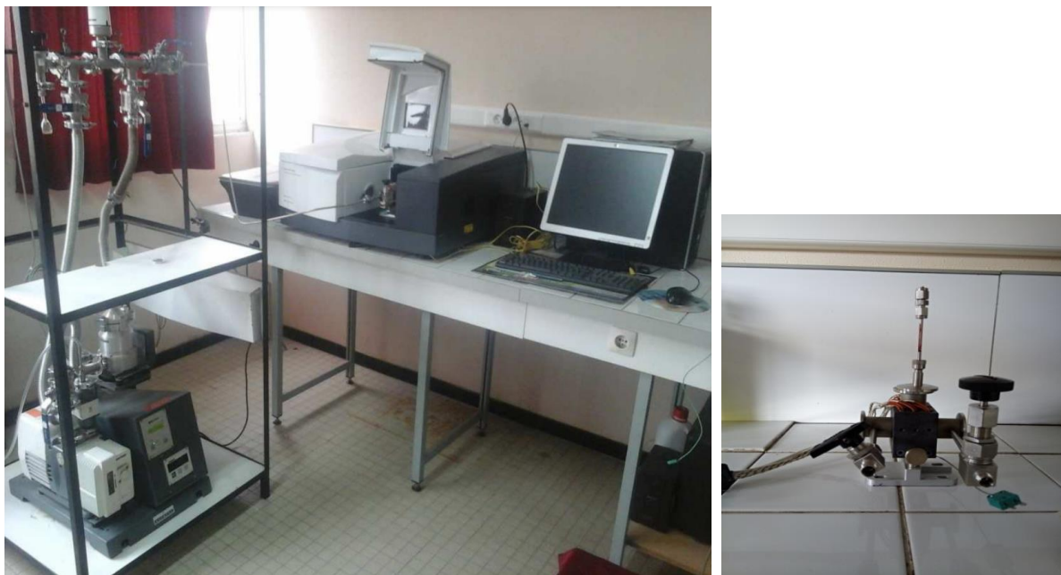
Figure II.11. Dispositif expérimental de l'adsorption de molécules sondes suivie par IR au LCSCO
