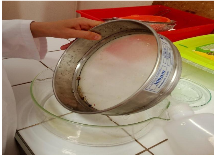
Figure33 : Tamisage humide (photooriginale,2024)
