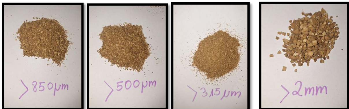
Figure 18 : Différentes granulométries des coques de noyaux d'abricots broyées granulométries.
