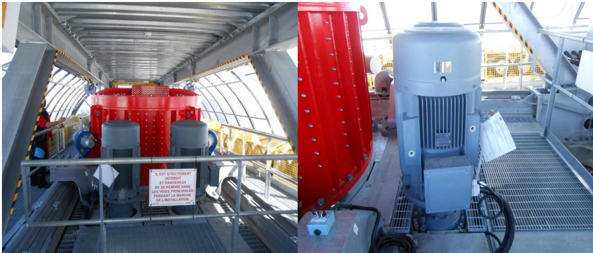
Figure 21 : Motoréducteur de secours [30]
