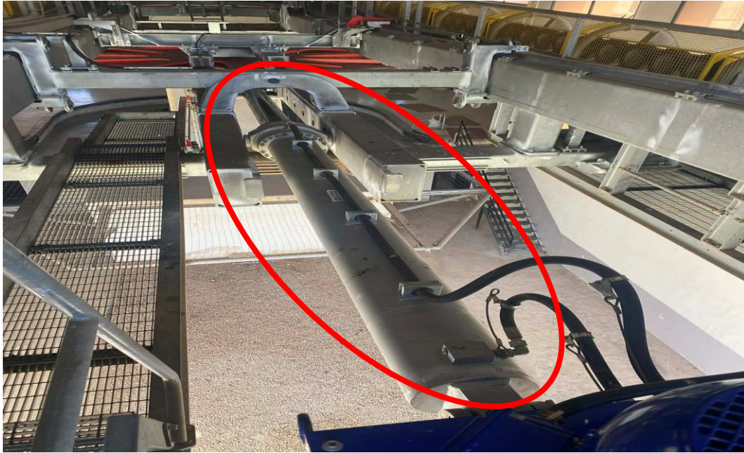
Figure 36 Un vérin hydraulique [Photo personnelle]
