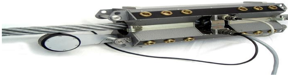
Figure 52 contrôle par ultrasons [40]
