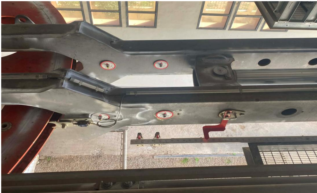
Figure 34 Une partie du lorry de tension en station retour [Photo personnelle]
