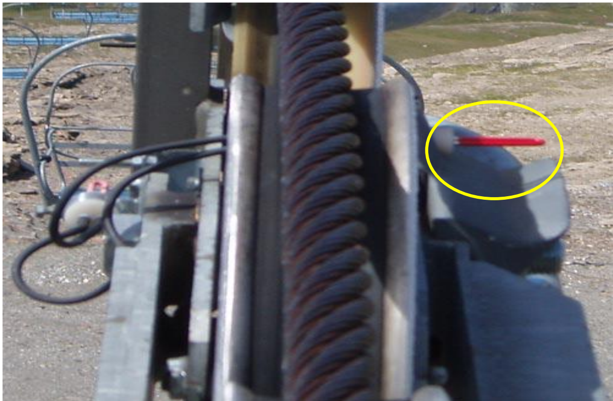
Figure 46 Capteur de déraillement (la double tige rouge) [9]
