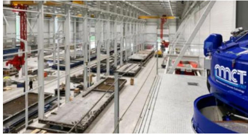
Figure 8 : HOLLANDE : CENTRALE À BÉTON ULTRAMODERNE POUR LA PRODUCTION DES ÉLÉMENTS PRÉFABRIQUÉS
