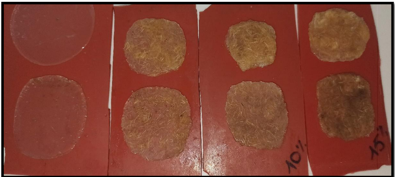
Figure II.3 : Les échantillons composites PLA/Alfa à différentes concentrations
