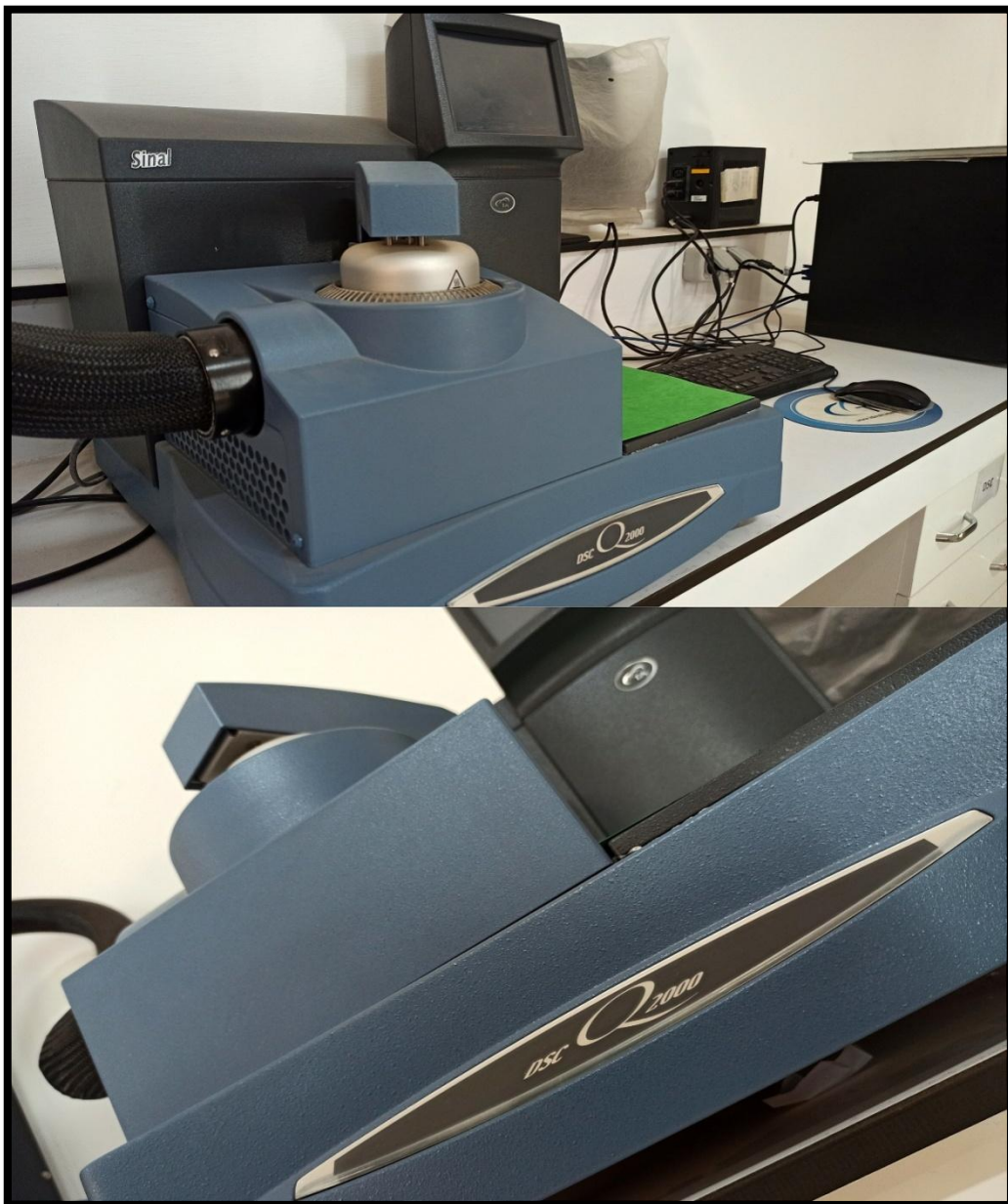
Figure II.7 : Analyse calorimétrique différentielle Q2000.
