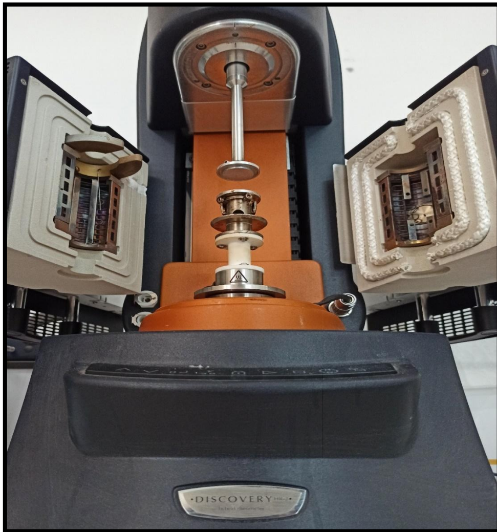
Figure II.8 : Rhéomètre Discovery Hybrid DHR2.
