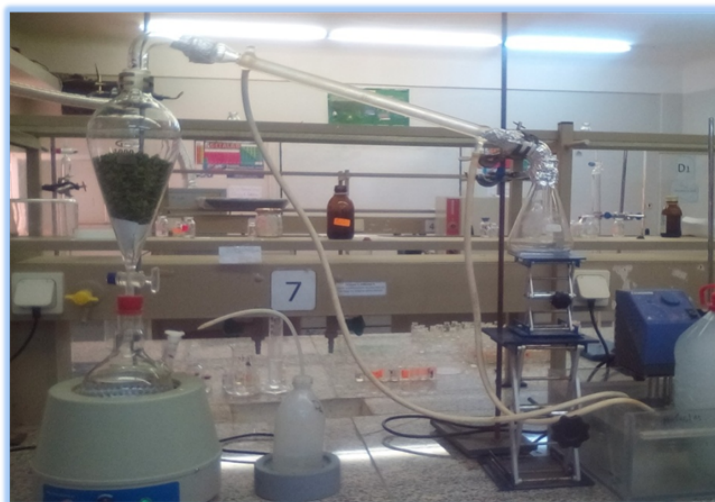
FIGURE 8 – Montage de distillation à la vapeur d'eau utilisé pour l'extraction des huiles essentielles
