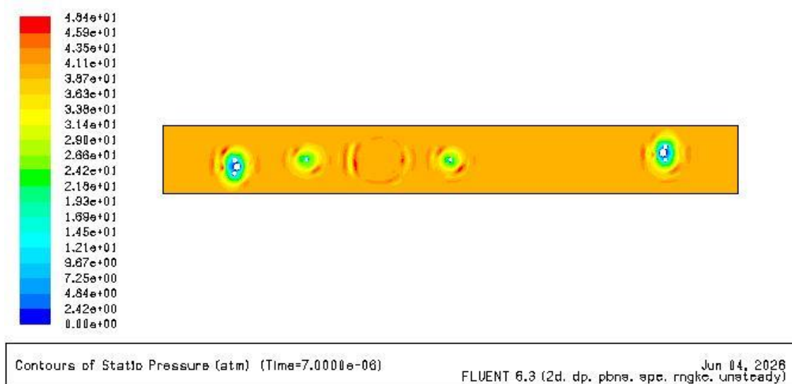
Figure 27 : Contour de pression dans la chambre de combustion
