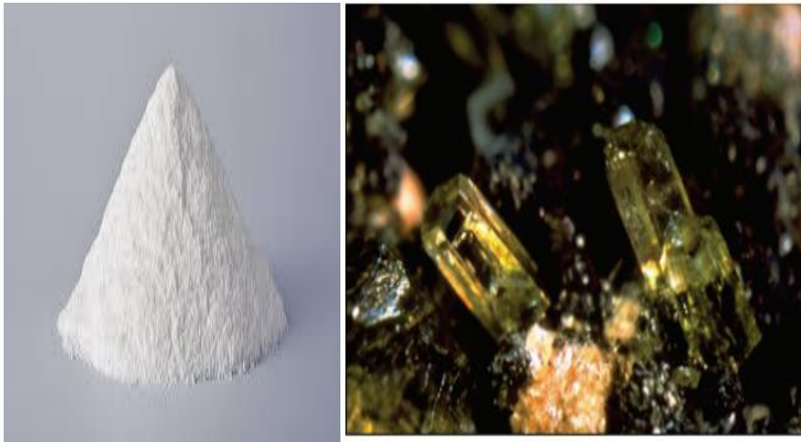
Figure 1 : L'oxyde de zinc
