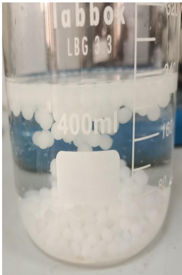
Figures 7: Formation des billes Alg-NPsZnO
