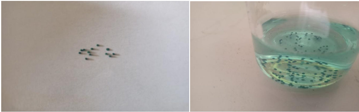
Figure 24 : Billes Alg-NPsZnO après adsorption de Vert de Cuve.
