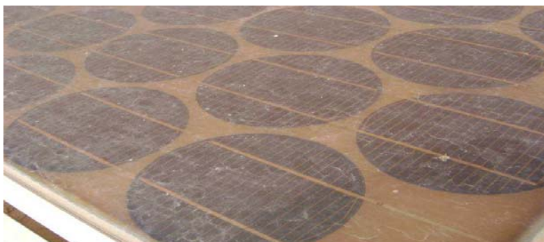
Figure - b- Etat de l'EVA sur la face avant du module PV (Jaunissement)
