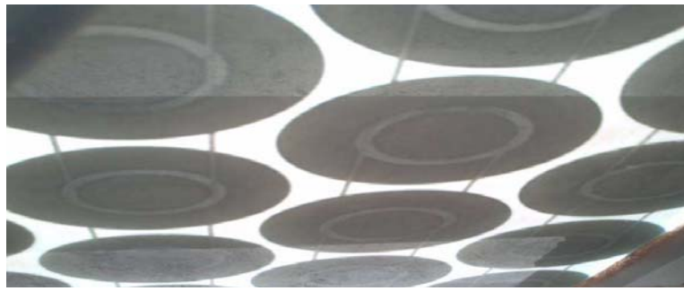
Figure -c- Etat de l'EVA sur la face arrière du module PV (accumulation de sable sur le côté)
