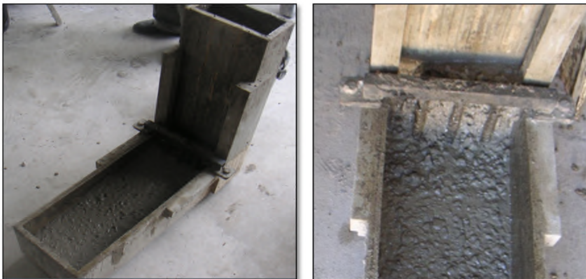
Figure IV.12. L'essai de la boit en L.
