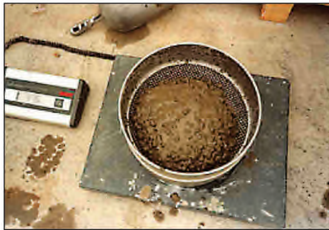
Figure II.4. Essai de stabilité au tamis (CUSSIGH, 2007).
