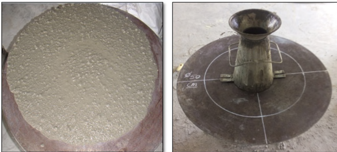
Figure IV.9. L'essai d'étalement au cône d'Abrams.
