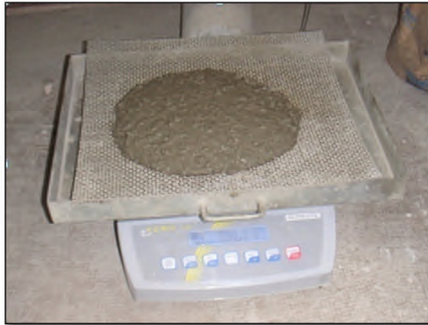
Figure IV.14. L'essai de stabilité au tamis.
