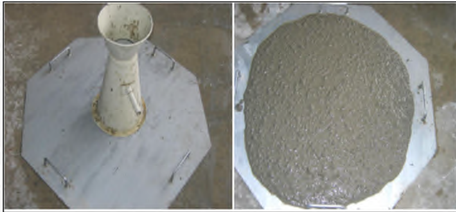
Figure II.2. Schéma du cône d'Abrams pour la détermination de l'étalement (Khelifa, 2009).
