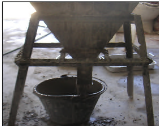
Figure IV.7. L'essai de V-Funnel.
