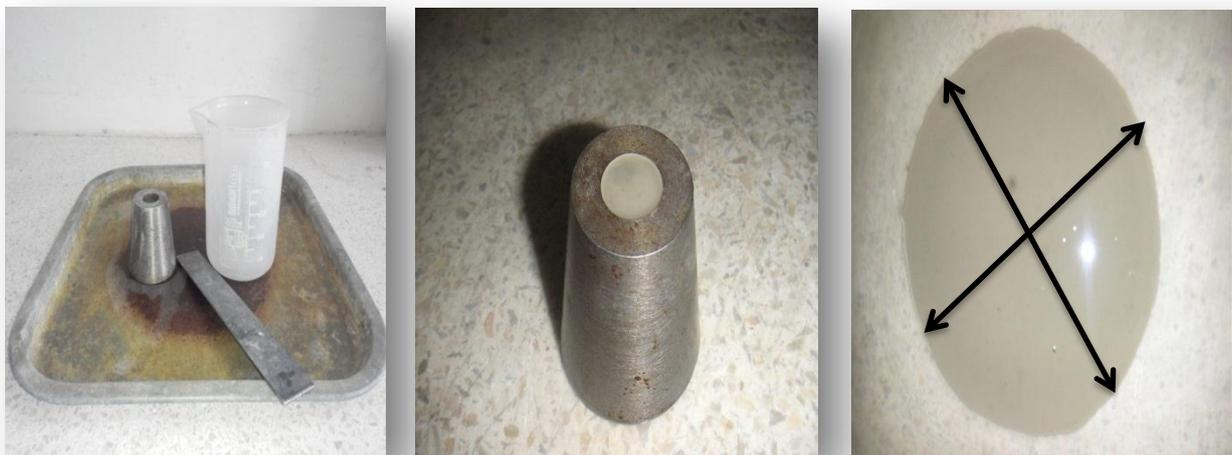
**Figure 3.7.** Essai Mini Cône.
