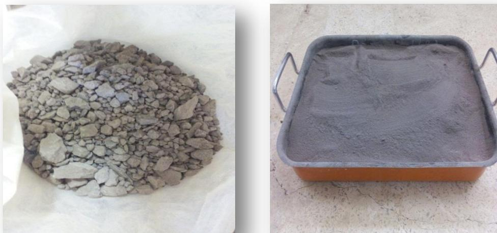
**Figure 3.5.** Échantillon de pouzzolane (avant et après broyage).
