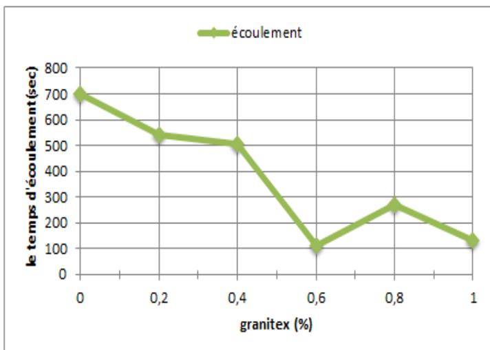
Figure 3.12: courbe dosage de saturation (cône de marsh)
