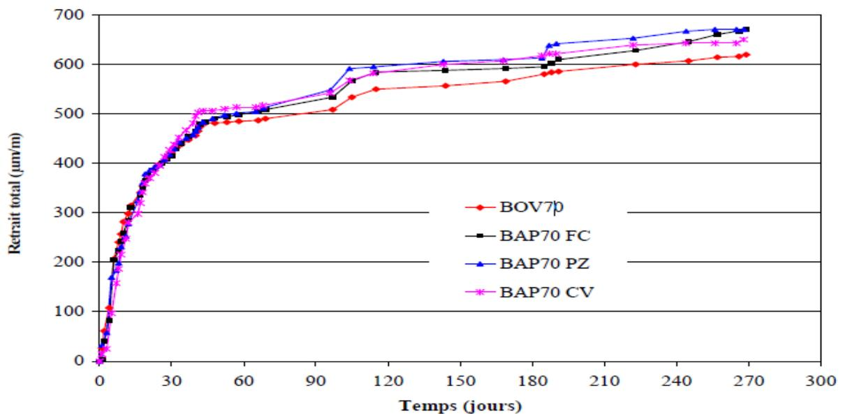
**Figure 2.14.** Evolution de retrait total des bétons de classe de résistance 70 MPa (SIAD, 2010).
