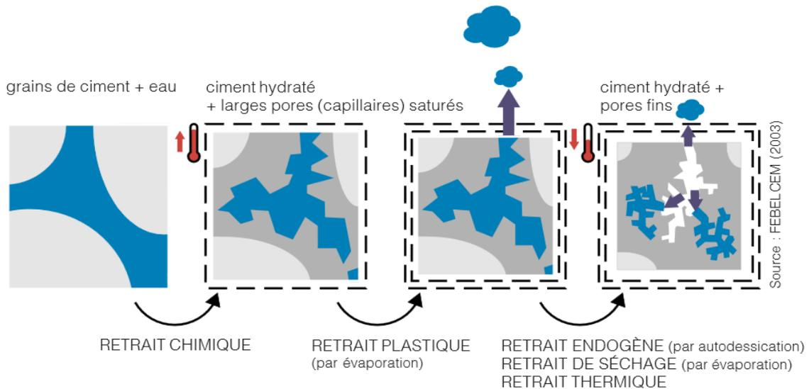
**Figure 1.3.** Evolution du retrait en fonction de l'âge du béton.
