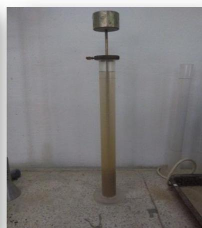
**Figure 3.1.** Essai équivalent de sable
