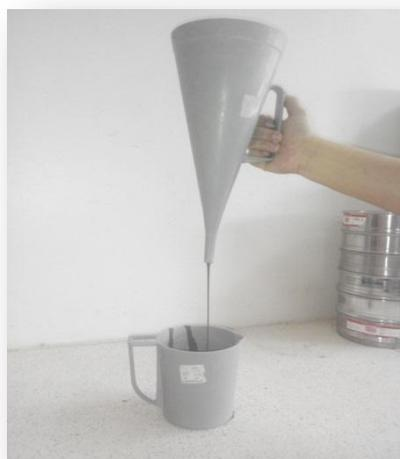
**Figure 3.6.** Essai au cône de Marsh
