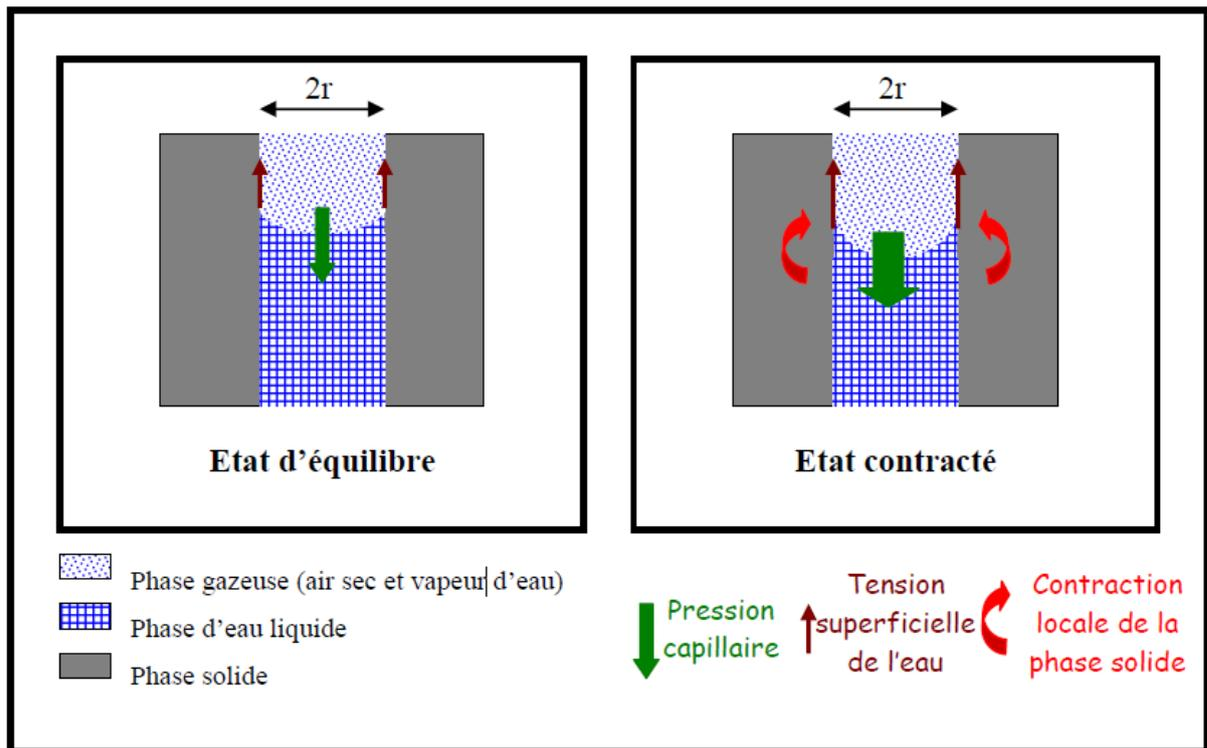
**Figure 1.13.** Schématisation du retrait par variation de pression capillaire (Flore BRUE, 2009).
