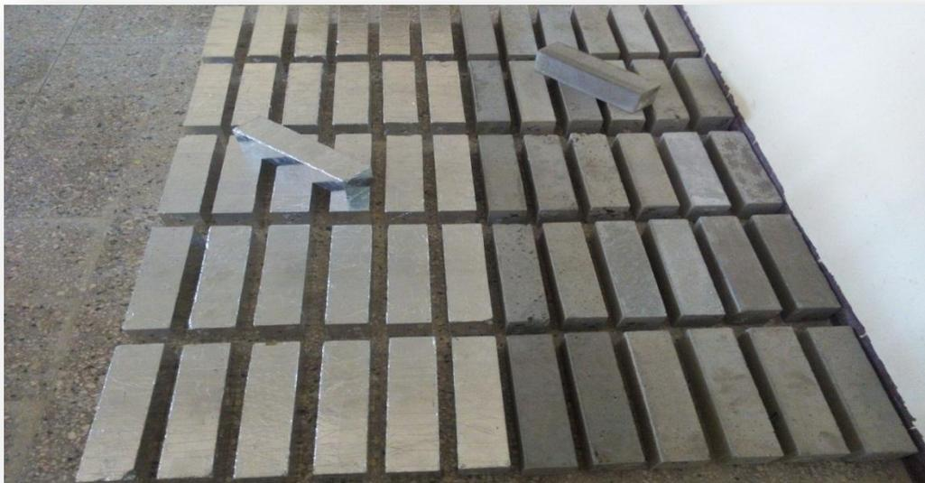
**Figure 4.4.** L'ensemble des épreuves confectionnées de différentes formulations.
