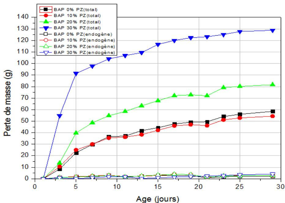
Figure 4.19. Perte de masse Béton auto-plaçant (pouzzolane%).
