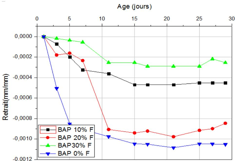
Figure 4.11. Le retrait de dessiccation des Bétons Auto-plaçant (% Filler)
