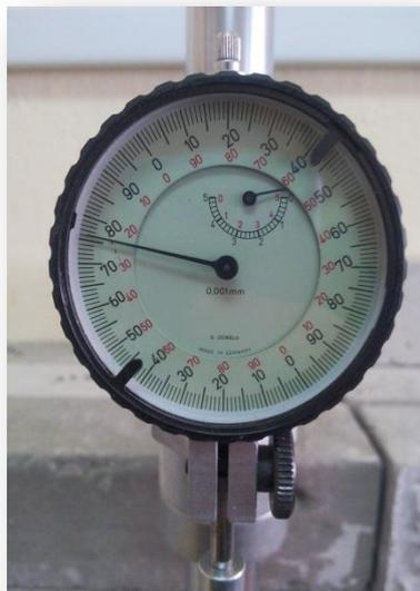
Figure 4.6. Rétractomètre
