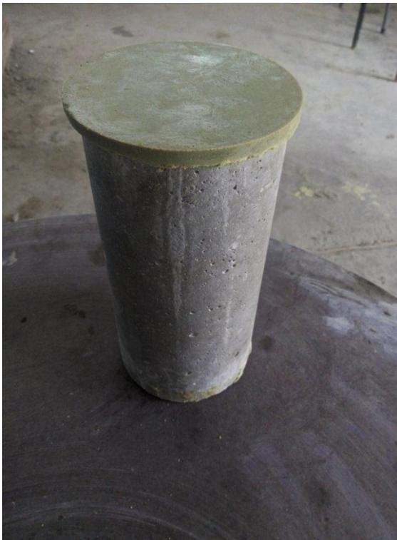
**Figure 4.8.** Surfaçage des éprouvettes
