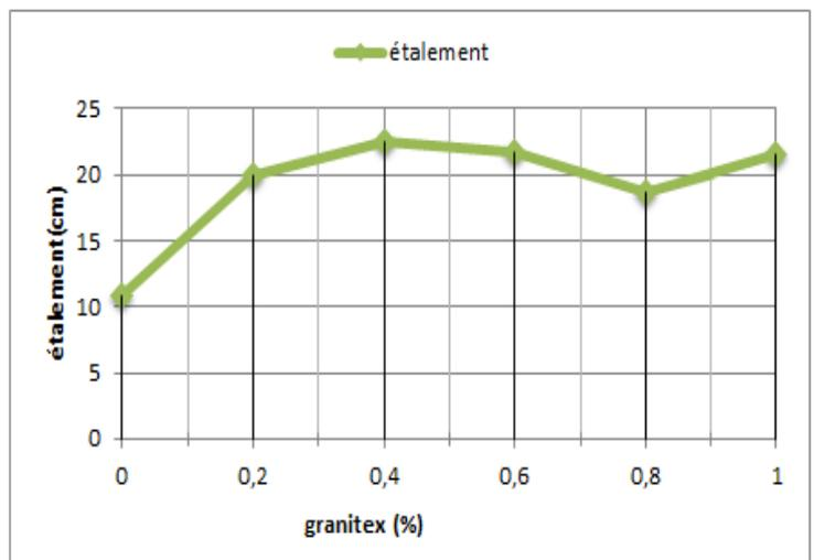
Figure 3.13 : courbe dosage de saturation (mini cône)
