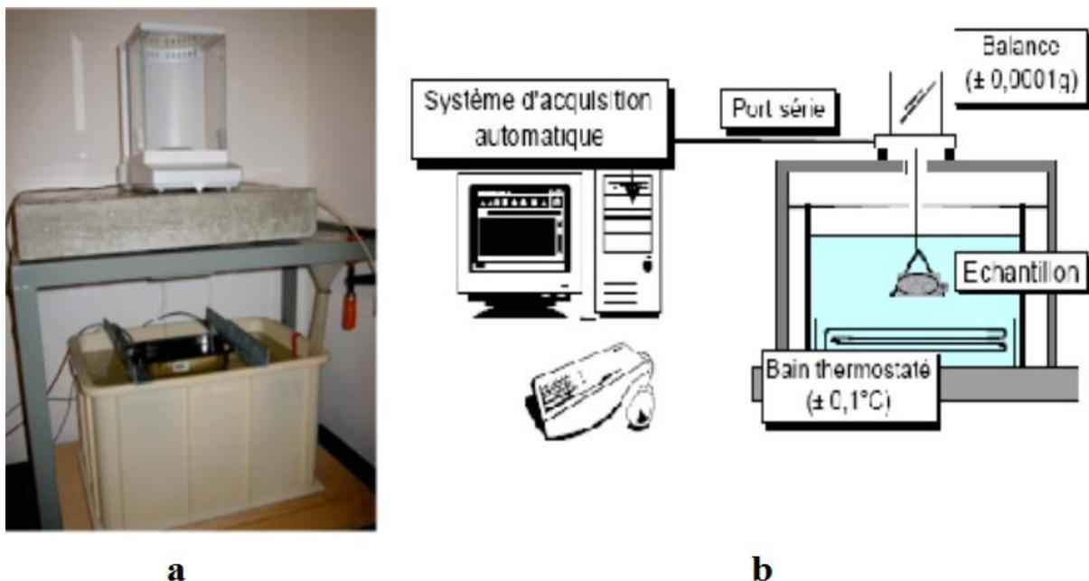
**Figure 1.17.** Schéma du dispositif de mesure de retrait endogène volumique (MOUNANGA, 2003).
