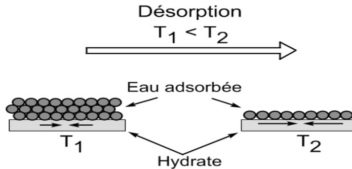
**Figure 1.9.** Schématisation du phénomène de tension de surface (adapté par CHARRON, 2002).
