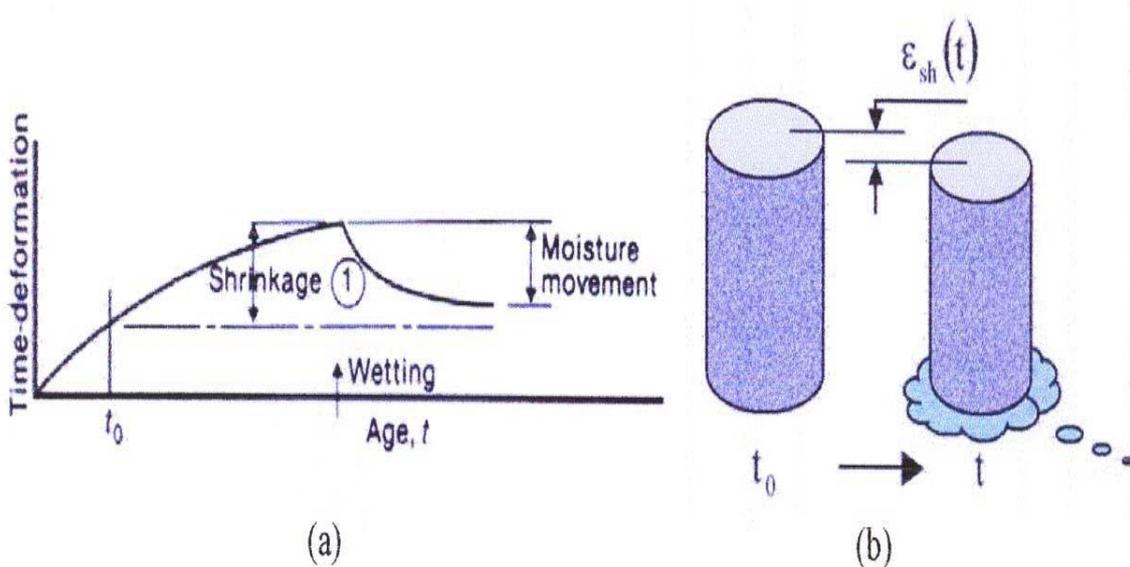
**Figure 1.2.** (a) Déformation différée de retrait d'un spécimen non chargé : Illustration de la cinétique de retrait (*shrinkage*) et du gonflement par variation hydrique (*moisture movement*) – (b) Variation volumique d'une éprouvette de béton au retrait (NEVILLE et al, 1983).
