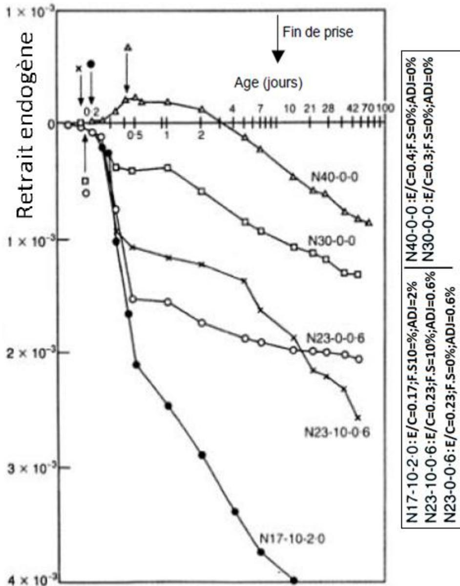
**Figure 2.2.** Influence du rapport E/C sur la cinétique et l'amplitude du retrait endogène. Les références des courbes indiquent (le type de ciment)-(le rapport E/C en %)-(la teneur en fumée de silice en %)-(le dosage en superplastifiant), (TAZAWA et col, 1998).
