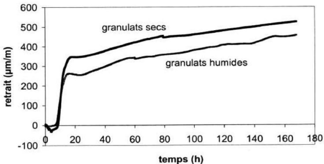
**Figure 2.18.** Effet de la saturation des granulats sur le retrait endogène (TOMA, 1999).
