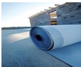
Figure III.6: Feuille de PVC d'étanchéité (Source : Tanguy, 2015)
