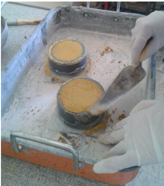
Figure 3. 8. Lissage de la surface et saupoudrage du démoulant (Photos prises par les auteurs)
