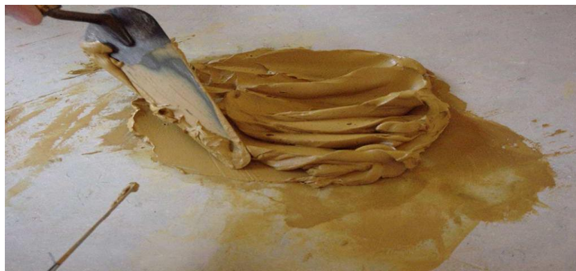
Photo 2.10 : Préparation de l'échantillon du sol soumis à l'essai
