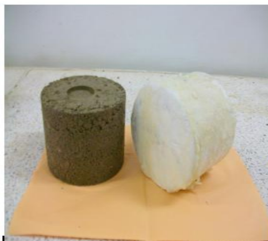
Photo 2.17 : Argile Bouhenak compactée
