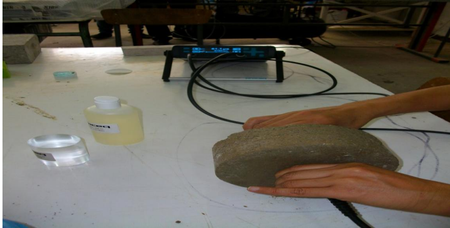
Photo 2.3 : Mesure du module d'élasticité E par la méthode d'auscultation dynamique ou ultrason.
