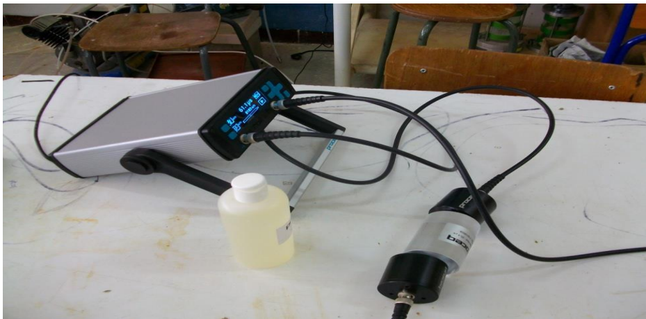
Photo 3.1 : Dispositif Pundit Lab
