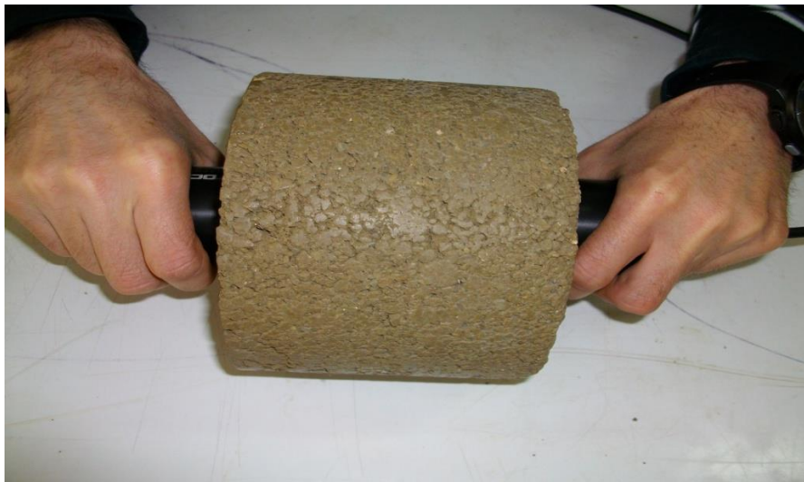
Photo 3.2 : Auscultation d'une éprouvette compactée
