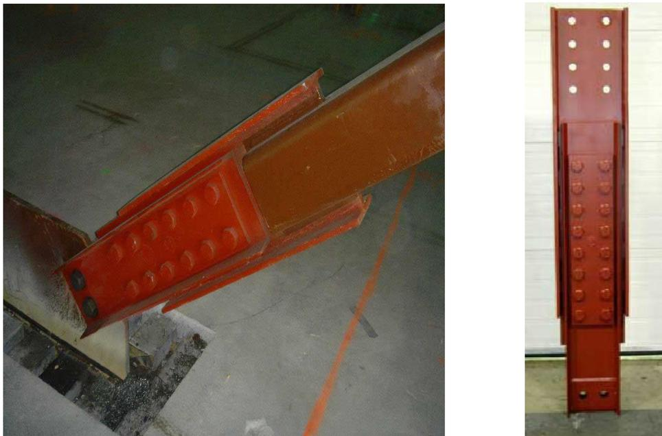
**Figure II.7 :** Amortisseur boulonné encoché [18] [10].
