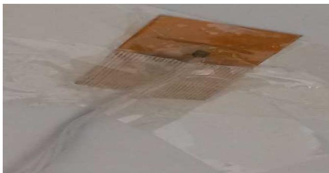
Figure 3.7. Capteur PT100 collé sur le dos du module PV sous test.
