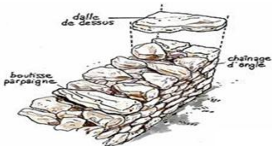
Figure 1.7 : Maçonnerie en moellons de pierre.
