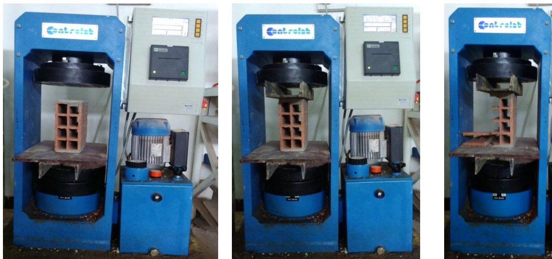
Figure 3.7 : Écrasement de la brique à l'aide de la presse universelle (photo prise par les auteurs).
