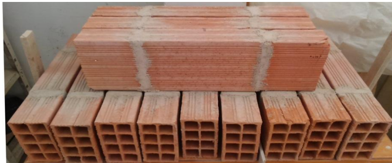
Figure 3.45 : Cure et stockage des triplets finis et prêts à l'écrasement (photo prise par les auteurs).
