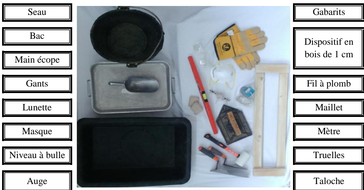
Figure 3.25 : Outils utilisés pour la construction des murets
