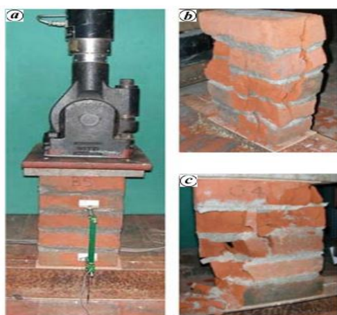
Figure 2.19 : Essai de compression des murs en brique pleine : (a) essai de compression sur prisme ; (b) et (c) modes de rupture des prismes [HEMANT 2007].
