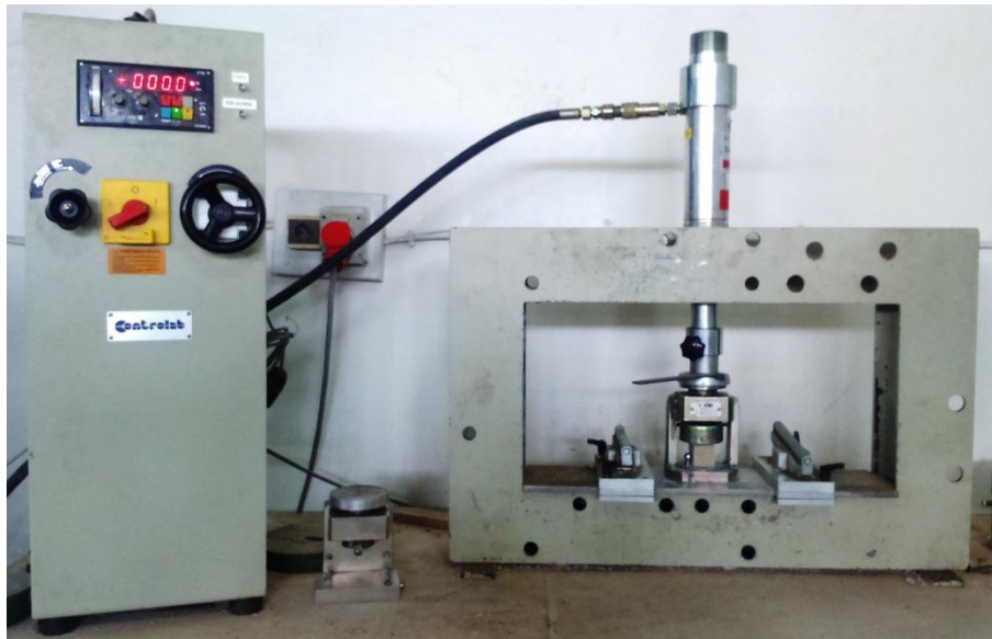
Figure 3.21 : L'essai de résistance à la compression à l'aide du banc d'essai didactique (photo prise par les auteurs).
