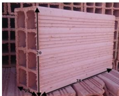
Figure 3.2 : Dimension de la brique creuse (photo prise par les auteurs).
