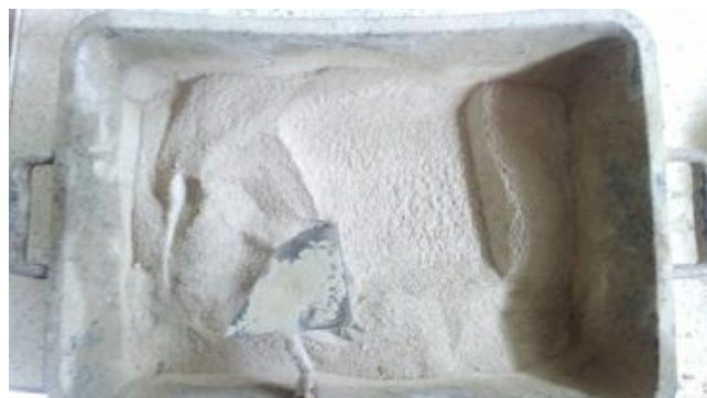
Figure 3.29 : Mélange à sec du mortier (photos prises par les auteurs).
