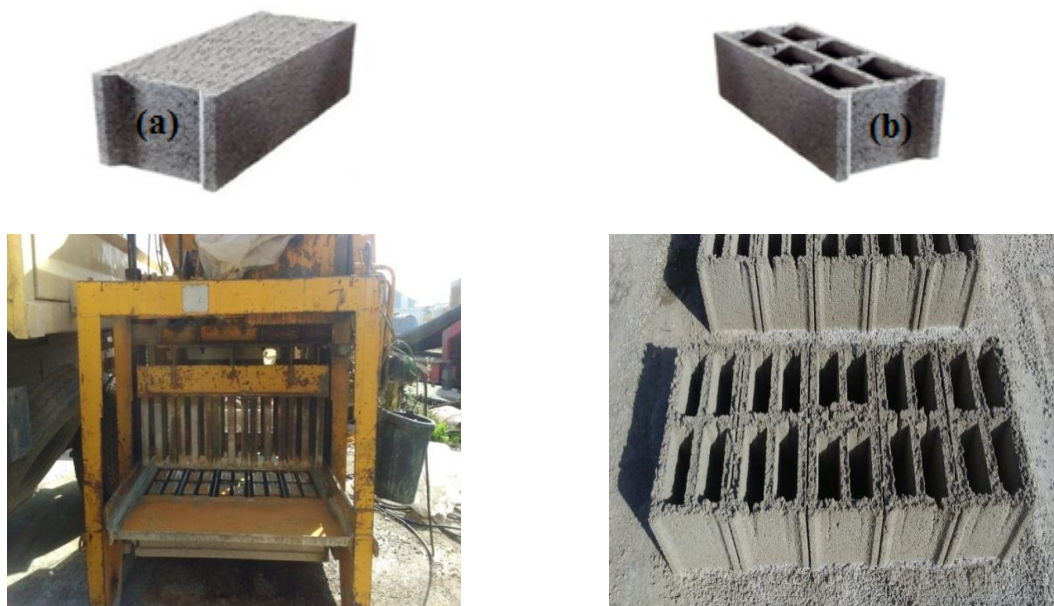
Figure 1.6 : Fabrication des parpaings (Sogerhwit 2016) (photos prises par les auteurs).
