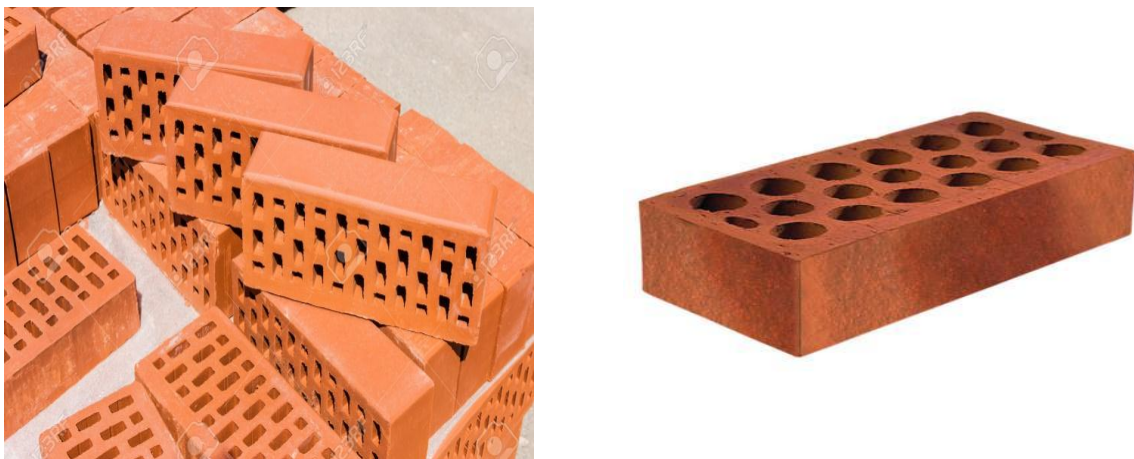
Figure 1.2 : Maçonnerie en brique perforée.
