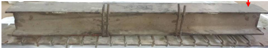
Figure 3.44 : Barres de transmission des charges (photos prises par les auteurs).
