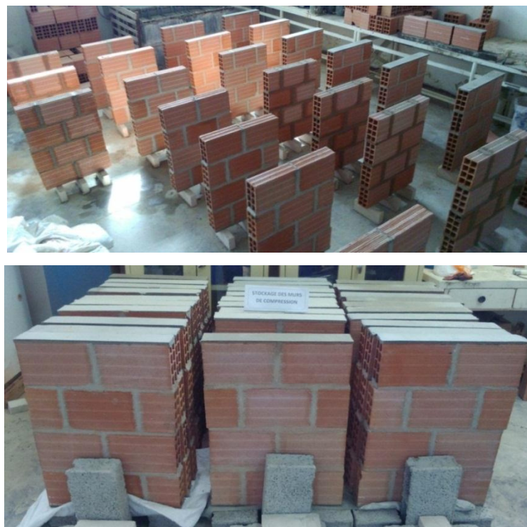
Figure 3.40 : Cure et stockage des murets soumis à la compression, finis et prêts à l'écrasement.
