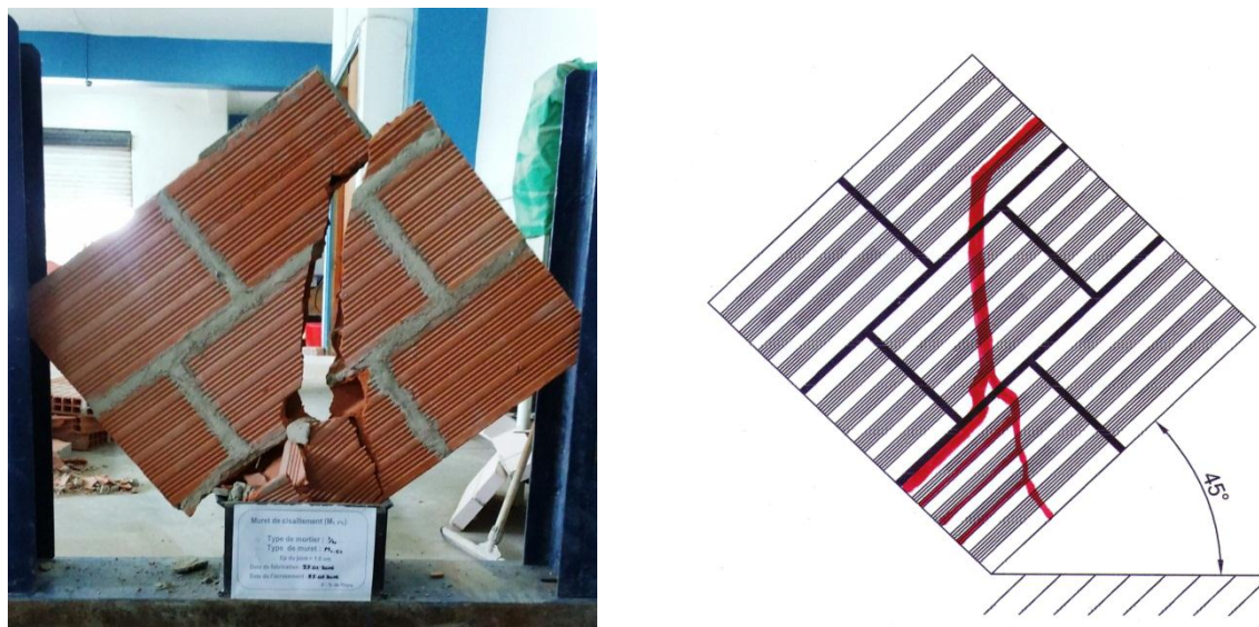
Figure 4.2 : Rupture en coup de sabre.
