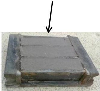
Moule prismatique 40x40x160 mm 3
