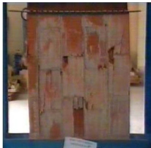
Figure 2.18 : Les modes de rupture de l'essai de compression uniaxiale [HOUTI 2002].
