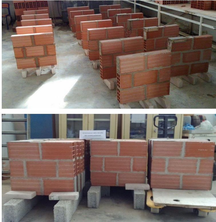
Figure 3.39 : Cure et stockage des murets soumis au cisaillement, finis et prêts à l'écrasement.
