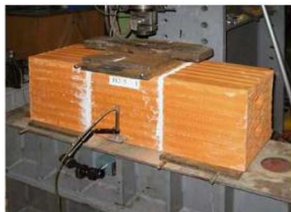
Figure 2.13 : Premier test de résistance au cisaillement selon la norme EN 1502-3 dans le laboratoire.
