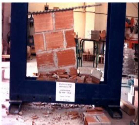
Figure 2.18 : Les modes de rupture de l'essai de compression uniaxiale [HOUTI 2002].
