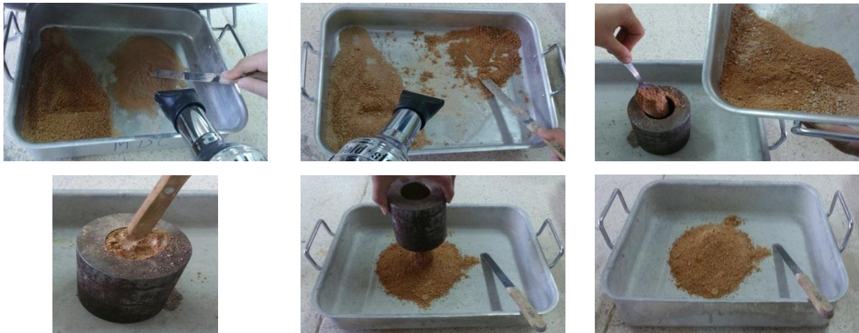
Figure 3.10 : Les étapes de la méthode utilisée pour la détermination du coefficient d'absorption du sable (photos prises par les acteurs).
