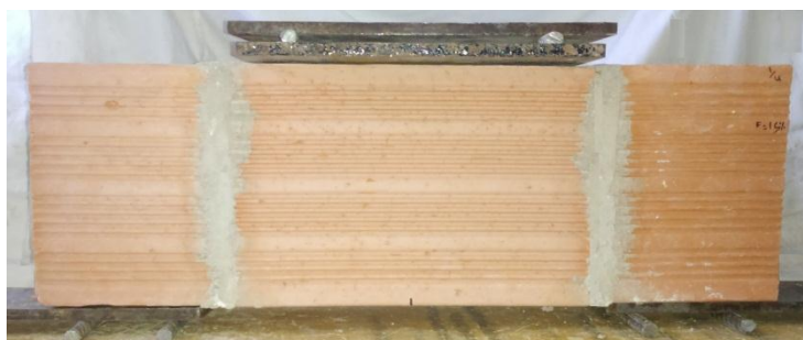
Figure 3.46 : L'essai de résistance au cisaillement à l'aide de la machine universelle de traction (photo prise par les auteurs).
