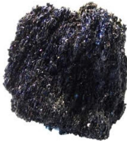
**Fig.1.1** Echantillon de carbure de silicium [\[Web01\]](#)
