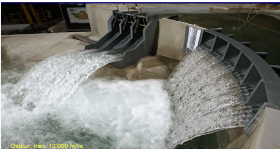
Photo I.4 : Essais sur modèle réduit, évacuateur du barrage Ostour Q = 12\,000\text{ m}^3/\text{s} .
