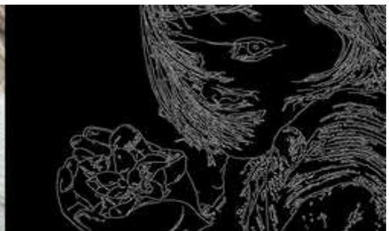
**Figure III.11 :** détection de contour (CANNY)
