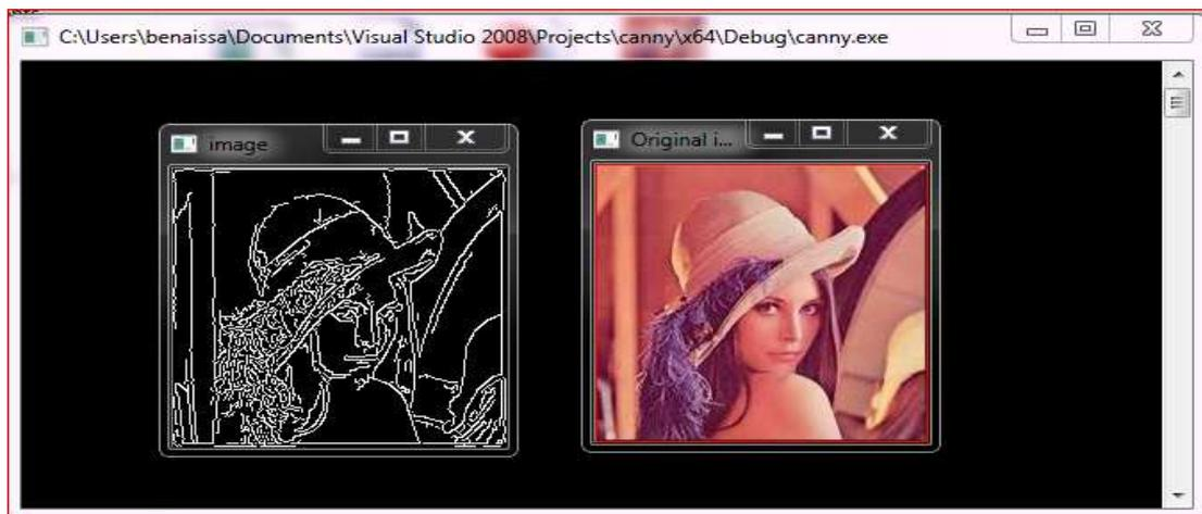
Figure IV. 2 : détection de contour d'une image (canny).
