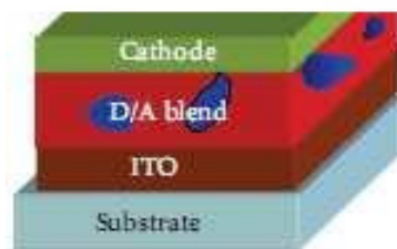
Figure II.9 : Structure d'un dispositif type à hétérojonction
