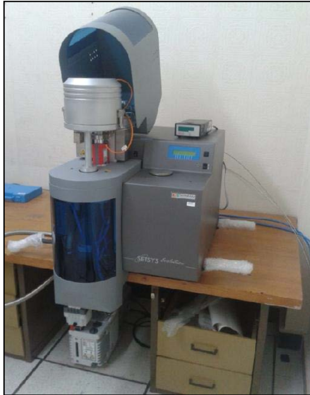
Figure II.9. Photo de l'appareil d'analyse thermique par DSC SetsysEv1500c.
