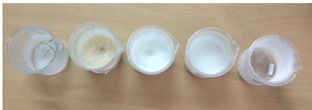
Figure II.6.d. Les Xéro-gels des échantillons d'orthosilicates après séchage
