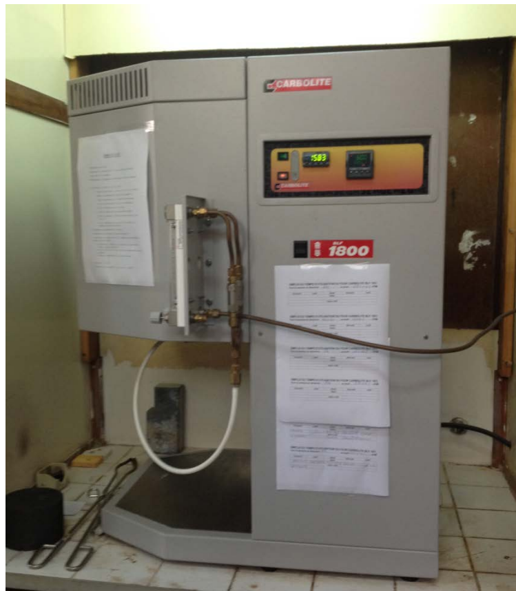
Figure II.6.c. Le four utilisé pour le recuit thermique des échantillons
