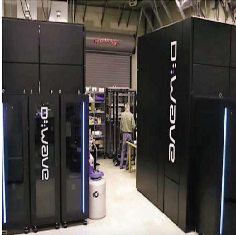
FIGURE 1.3 – Ordinateur quantique à silicium scalable "D-wave2" de 512 qubits fabriqué en 2013. Documents D-waves systems.
