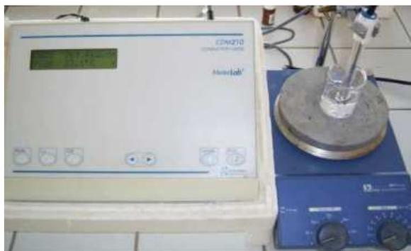
**Figure 9:** Conductimètre CDM210
