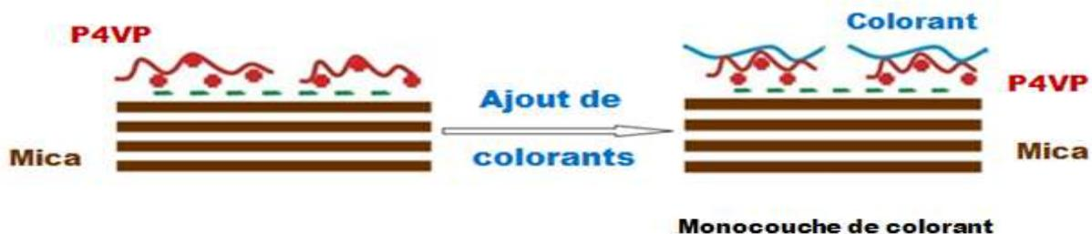
**Figure 1** : Concept de fixation du colorant sur le matériau composite
