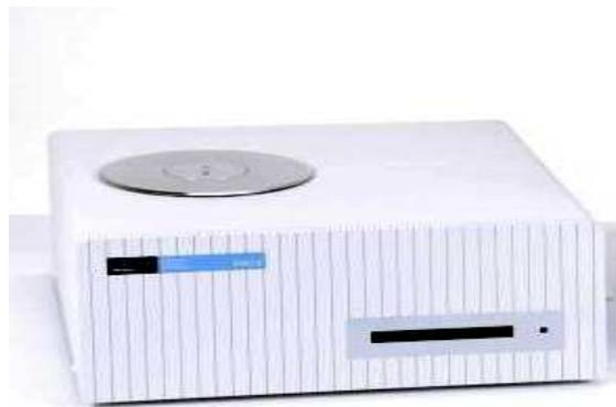
**Figure 5** : Appareil DSC Pyris 6
