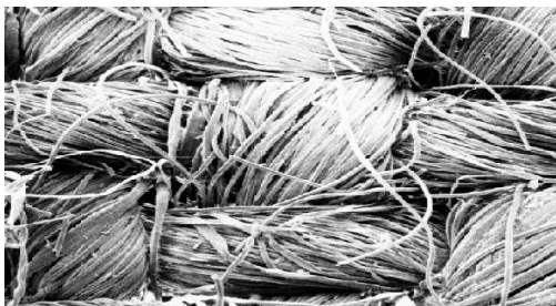
Figure 2.5.a- Dans une toile, les fils de coton entrecroisés sont faits de faisceaux de fibres (microscopie électronique, cliché A. Boudet) Figure 2.5.b- Dans une fibre à haute résistance, les molécules (en vert) sont parallèles et sont reliées par des nœuds ou par des liaisons hydrogène (en jaune)
