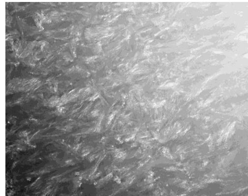
Figure 2.3.2.b- Cristallites dans du polyéther-éther-cétone (microscopie électronique en transmission, (cliché A. Boudet)
