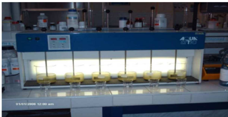
Figure II.6 : Photo du jar test utilisé pour traitement.
