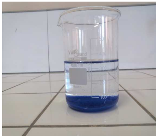
Figure V.13 : Floccs formés à la fin de procès de coagulation/floculation de BM avec la bentonite seule.
