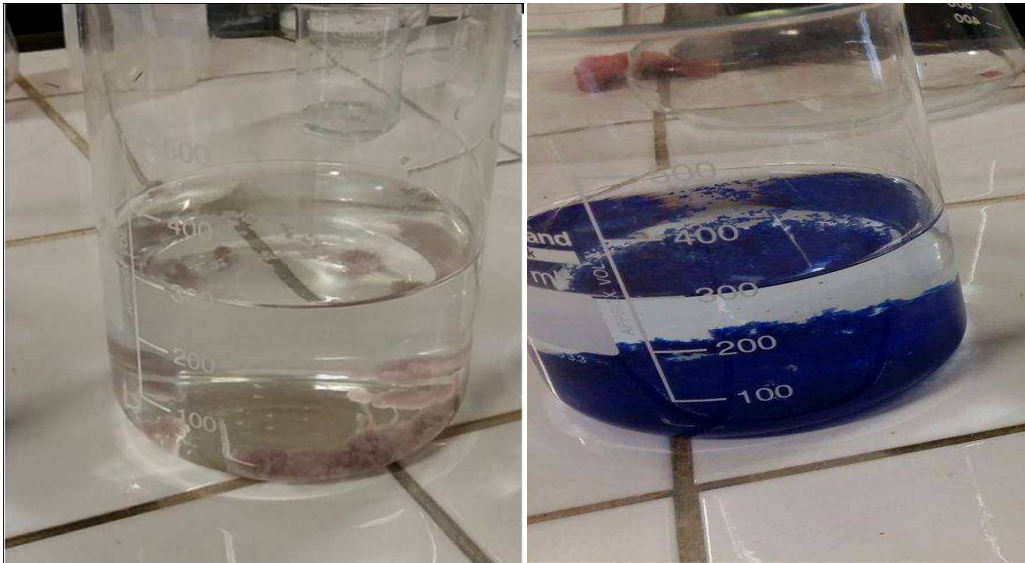
Figure IV.12 : Floccs formés à la fin de procès coagulation/floculation
